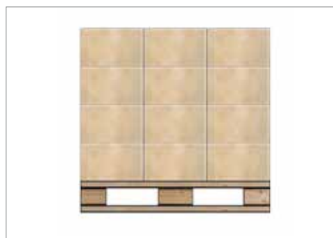
Afmetingen hetzelfde als van de pallet met een goede uitlijning
