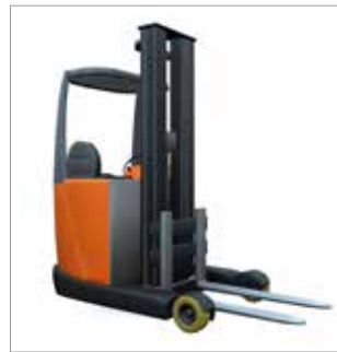
Heftruck met intrekbare of verstelbare mast
