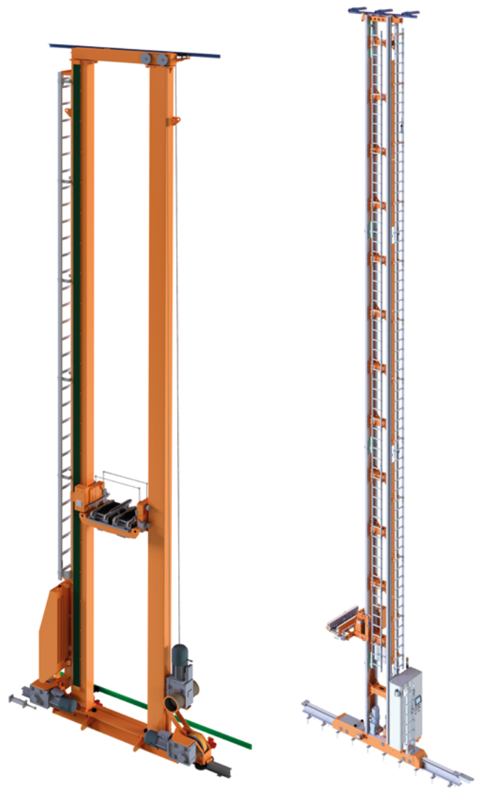
MLB100Q-stapelkraan met dubbele mast Bereikt hoogtes tot 20 m en verwerkt twee laadeenheden van 100 kg of vier van 50 kg.
