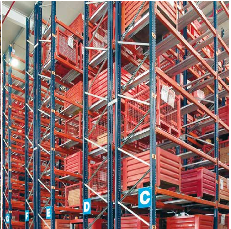
Conventionele palletstellingen met metalen containers
